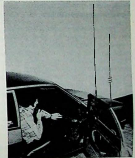
Fensterantennen für das 2-m- und 70-cm-Band von Hirschmann während des Funkverkehrs
